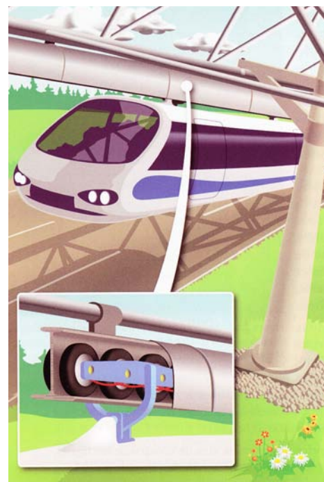
Monorail interurbain à grande vitesse mû par 16 moteurs-roues. Source : LANGLOIS, Pierre. Rouler sans pétrole , Éditions Multimondes, 2008, p 118.
